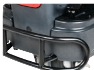
Zderzak przedni chroniący maszynę przed uszkodzeniami
